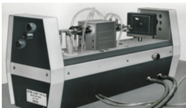
A BUDAPESTI NEMZETKÖZI VÁSÁRON KIÁLLÍTOTT ELSŐ FESTÉK LÉZER, MELYET A KÍSÉRLETI FIZIKAI TANSZÉK KUTATÓI KÉSZÍTETEK
